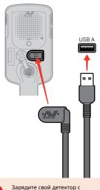
Зарядите свой детектор с помощью высококачественного зарядного устройства через USB с минимальной зарядной емкостью 2 А при 5 В. При использовании некачественного зарядного устройства существует риск выхода из строя зарядного устройства с USB.
